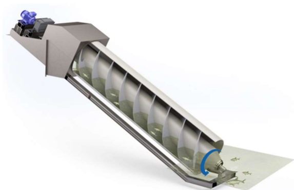
Figur 3.7. Figuren viser Pumpe 1. Illustration af udformning og funktion af pumpe i lukket cylinder.
