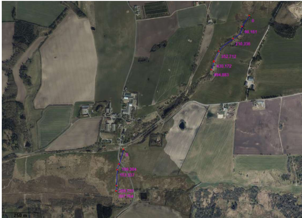
Figur 21: Kort over opmålinger foretaget som del af projektet. Der er foretaget en opmåling af bundkoter i den øvre del (øverst til højre) og den nedre del (nederst midtfor) af vandområdet.
