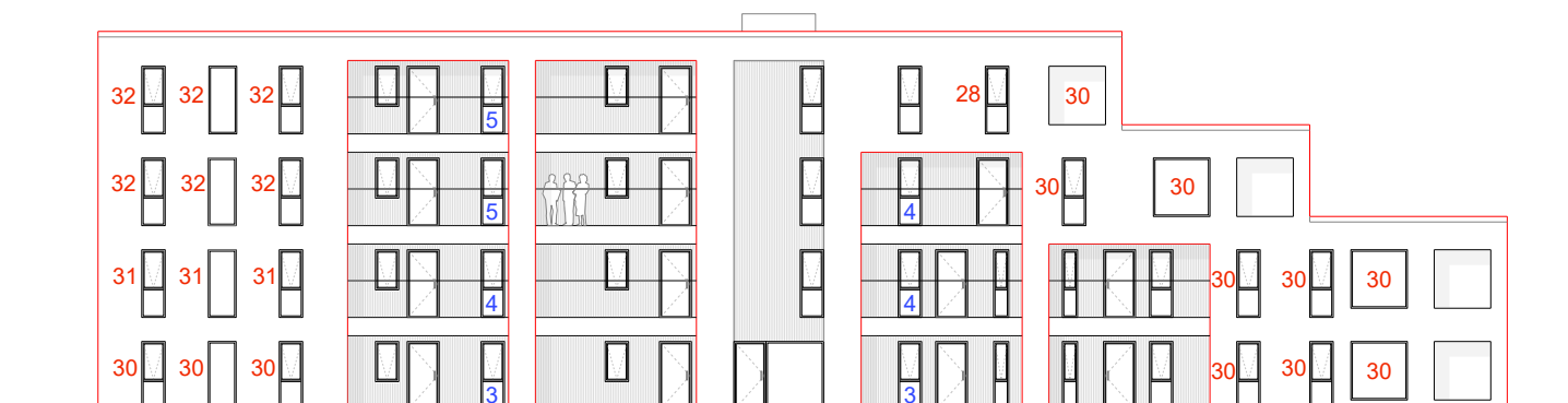
Illustration 11: Funktionskrav til vinduer i facaden mod Randersvej/Himmerlandsgade. Røde tal angiver funktionskravet ved lukkede vinduer mens de blå tal angiver funktionskravet med åbent vindue.
