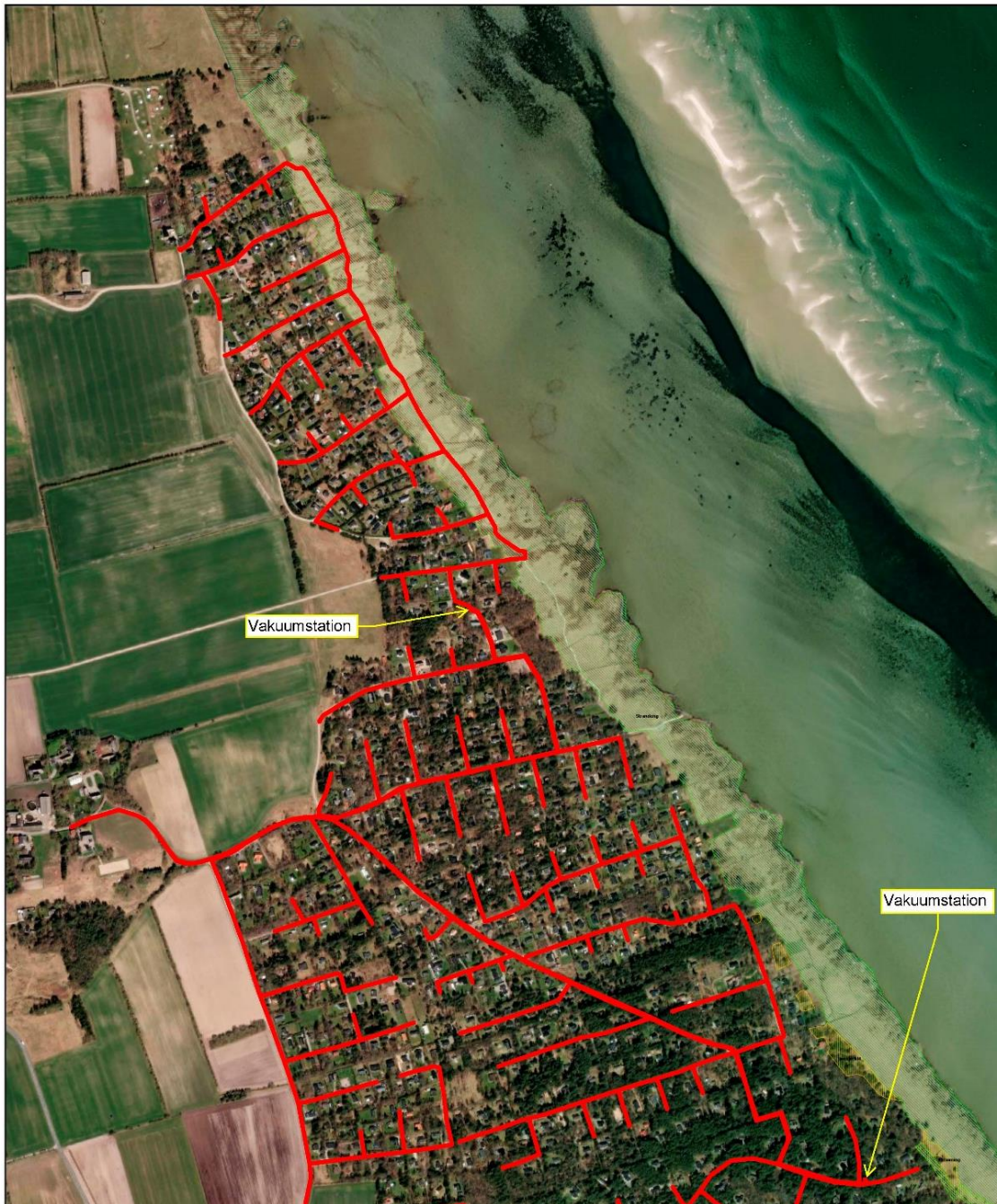
Figur 4-2. Figuren viser de planlagte ledningsarbejder og placeringen af vakuumstationer i den nordlige del af projektområdet i forhold til beskyttede habitatnaturtyper.
