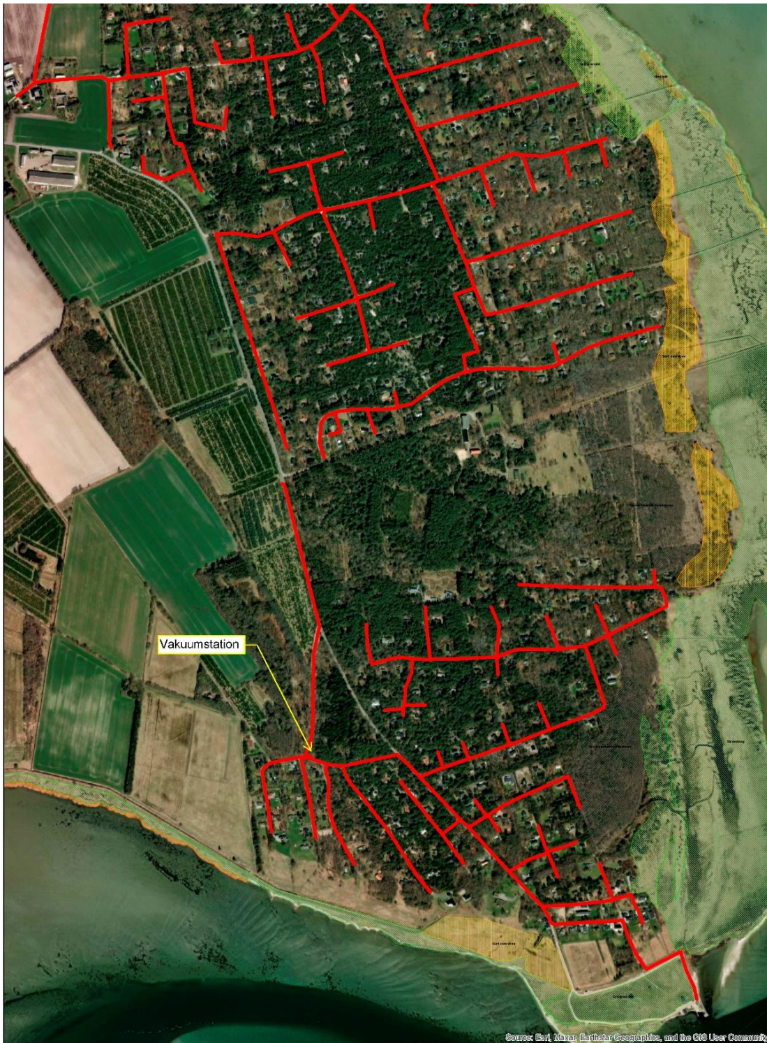
Figur 4-3. Figuren viser de planlagte ledningsføringer og placeringen af vakuumstation i den sydlige af projektområdet i forhold til beskyttede habitatnaturtyper.
